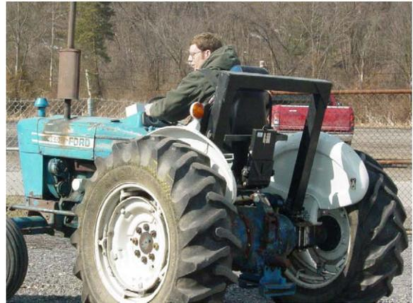
Fig. 7. Driving the AutoROPS-equipped tractor.
